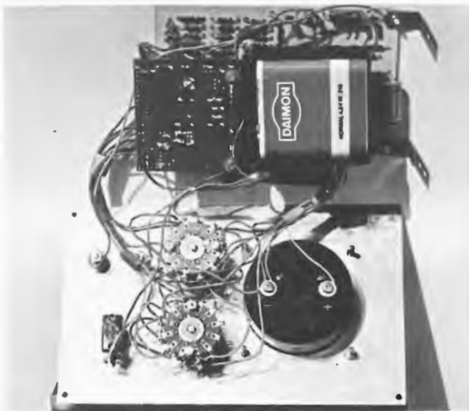
Foto 9. Interno del multimetro con trasformatore di corrente continua montato su una seconda piastrina
