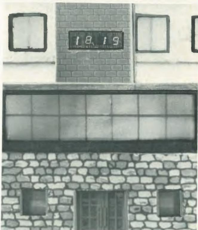
Foto 2. Cabina di manovra auto-costruita con orologio incorporato. Sicuramente la fantasia del ferromodellista troverà altre possibilità di utilizzazione di un circuito del genere
