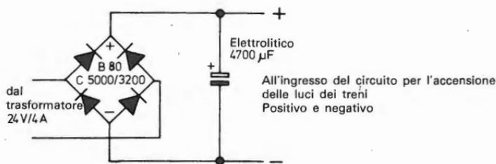
Fig. 22. Semplice alimentatore per il circuito per l'illuminazione dei treni
