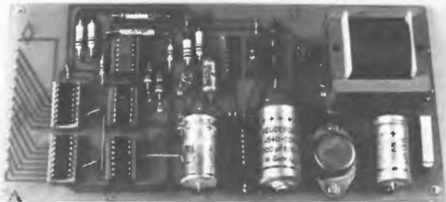
Foto 9. (a sinistra) La bassetta del generatore di note; gli interruttori ed i potenziometri sono facilmente accessibili
