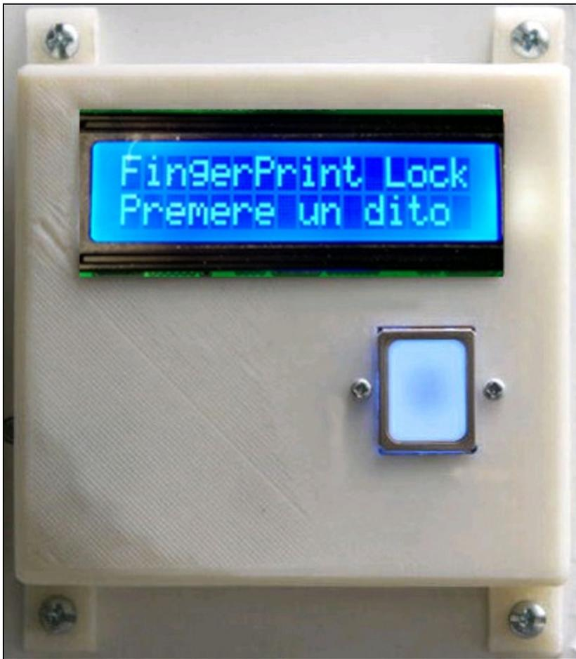
**Figura 7.3** Il contenitore per il display e il sensore.
