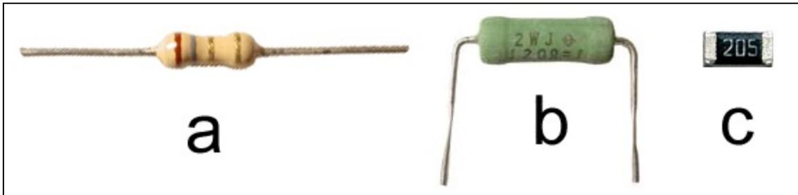
**Figura 1.10** A sinistra, un comune resistore fisso con il valore in  $\Omega$  riportato secondo un codice colori (a). Al centro, un resistore di potenza con il valore stampigliato per esteso (b). A destra, un resistore SMD ingrandito (c).
