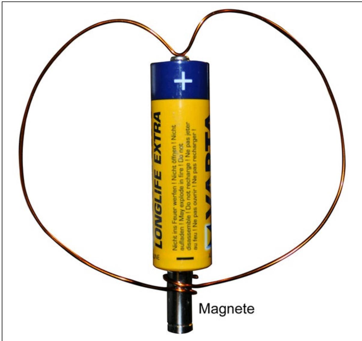
**Figura 1.21** Principio di induzione elettromagnetica. La bobina di rame poggia sul polo positivo della pila e sulla calamita cilindrica posta sotto e collegata al polo negativo della pila. La bobina genera così un campo magnetico. Il campo magnetico della bobina tenterà di sfuggire al campo magnetico della calamita ruotando attorno alla pila.
