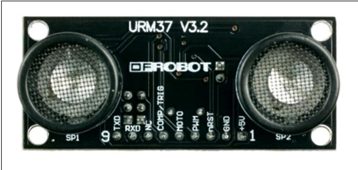
**Figura 1.52** Il sensore a ultrasuoni URM37.
