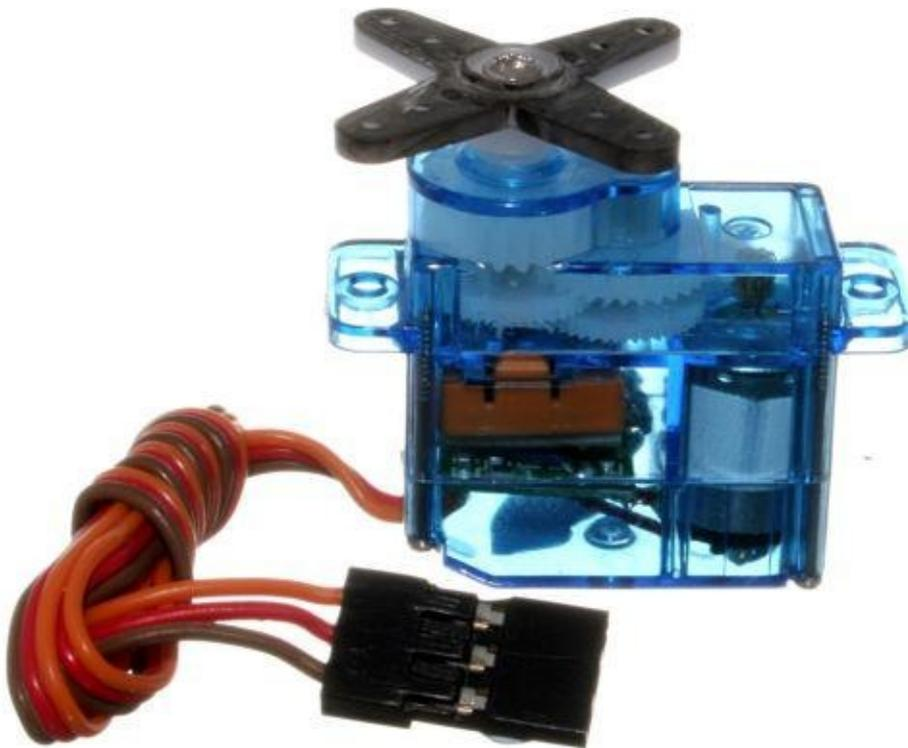
I servomotori sono composti da un motore che consente di effettuare il movimento e un sensore di posizione che indica esattamente in che punto si trova.
