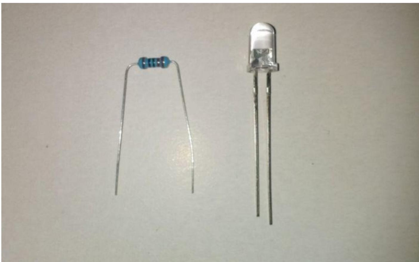
Il diodo LED (*Light Emitting Diode*) è un componente che se attraversato da una corrente
