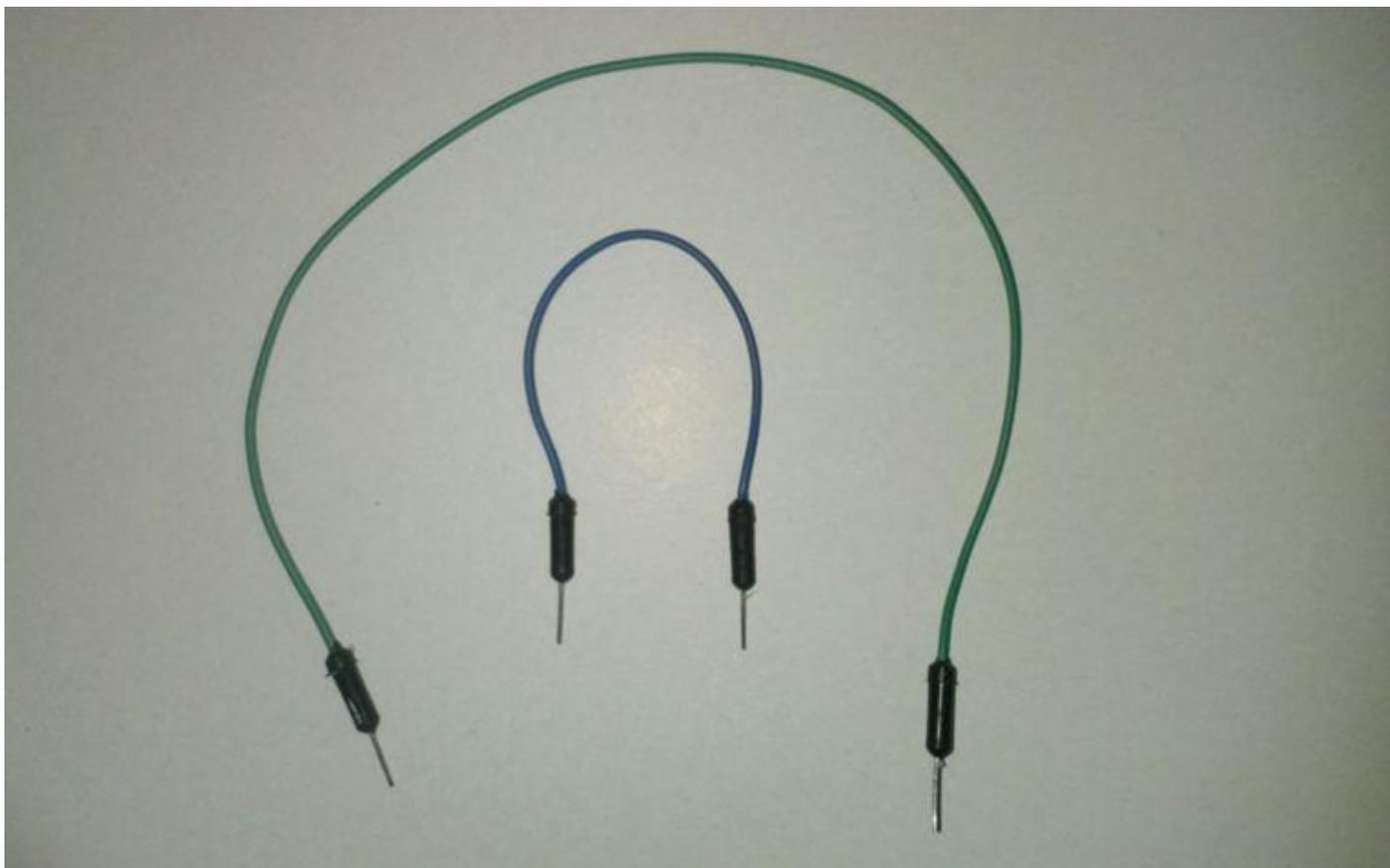
Sono cavetti di diversa lunghezza e di diverso colore che terminano con un connettore maschio – maschio adatto per connettersi ai Pin della scheda Arduino Uno fino alla Breadboard.
