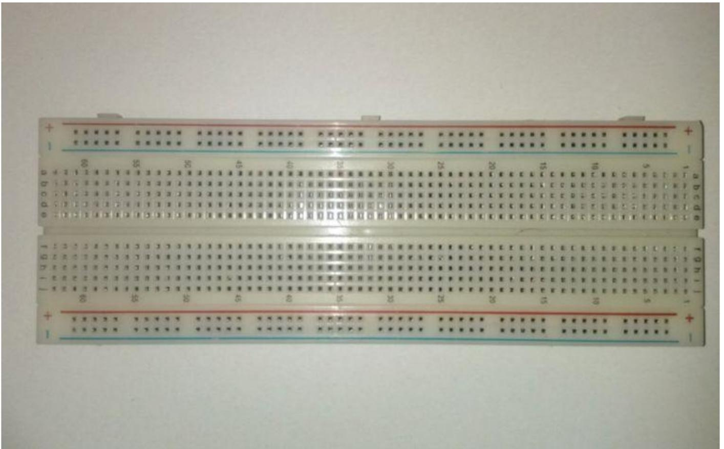
La breadboard (o basetta sperimentale) ti sarà molto utile per moltissimi dei progetti che andrai ad affrontare in questa collana di Arduino.
