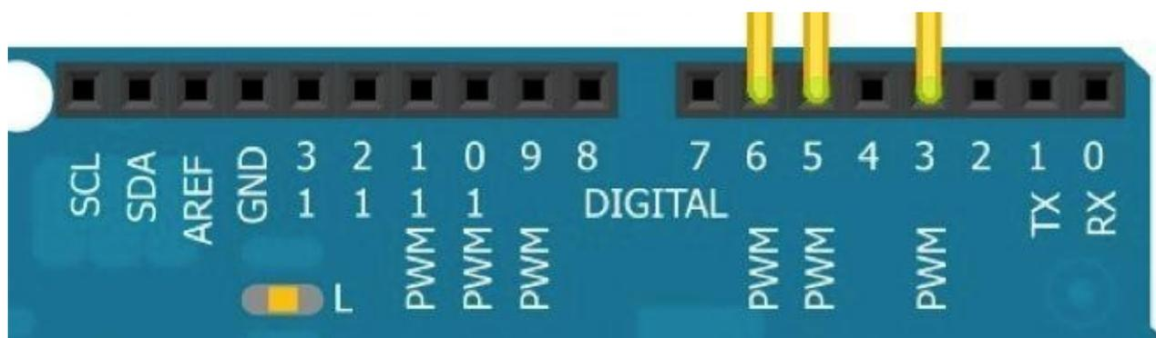
Questi Pin hanno la possibilità di fornire valori variabili e non fissi (come 0V – 5V) permettendoti così di regolare la luminosità di un LED.
