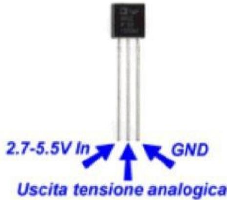
Questo tipo di sensore è uno dei più precisi e ha la possibilità di lavorare a tensioni bassissime 2,2V – 5V.
