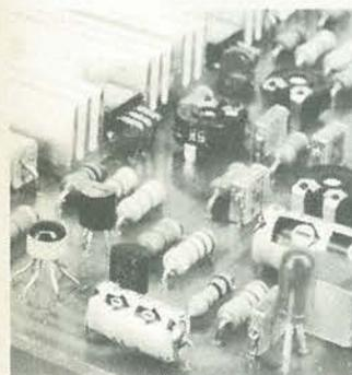
Stentore è il nome dell'amplificatore qui descritto che, eroga la potenza di 50 radio a transistor. Una caratteristica che distingue questo amplificatore è che è portatile visto che può essere alimentato da una normale batteria da automobile da 12V e di conseguenza risulta l'ideale per la diffusione circolare all'aria aperta.
