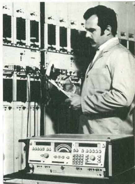
Oltre ai soliti tasti, c'è la possibilità di scegliere frequenze fisse distinte, uno scorrimento automatico delle frequenze e tutte le regolazioni dell'apparecchio possono essere memorizzate e poi richiamate semplicemente premendo dei tasti. Questa procedura diventa particolarmente comoda quando si devono fare delle misure ripetitive.
