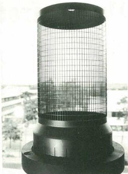
Attualmente la Siemens impiega griglie di grafite nei tetrodi di trasmissione per onde lunghe, medie e corte. Il programma di produzione va dalle griglie da 100 kW (RS 2054 SK) con diametro di 90 mm ed altezza di 170 mm alle "supergriglie" da 1200 kW (RS2084 SK) con diametro di 21 cm ed altezza di 45 cm.
