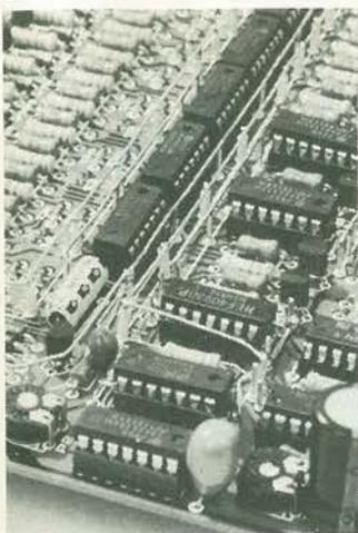
La caratteristica più originale nel progetto trattato in questo articolo è che s'impiega un solo interruttore per controllare sino a 15 uscite, con la possibilità di operare sia in "digitale" che in "analogico" (in unione all'indicazione visiva delle condizioni di ciascun canale).
