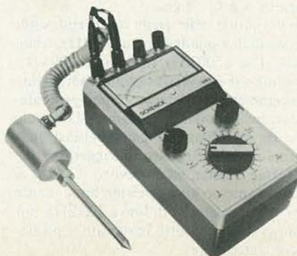
Non sono necessari ulteriori calcoli. Per la registrazione dei valori di misura e per la visualizzazione delle curve sono previste spine di allacciamento a un registratore od oscillografo. Il VIBROMETER 3 lavora senza necessità di allacciamento alla rete essendo equipaggiato con batterie a secco di tipo commerciale.
