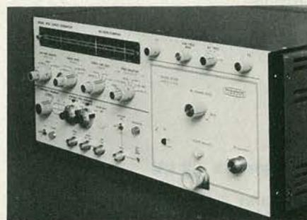
Altre caratteristiche comprendono uno sweep a larga banda da  $F_1$  a  $F_2$ , uno sweep a banda stretta AF, 3 frequenze CW, un marker variabile e come opzioni altri marker variabili più marker di armonica controllati al quarzo.
