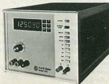
l'impiego nella calibrazione di trasduttori di potenza e wattmetri, come riferimento elettrico per la calibrazione di contatori, e per la misura delle perdite nel nucleo dei materiali magnetici.
