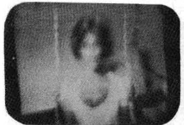
Figura 1-A - Esempio di immagine televisiva ottenuta con la presenza di un condensatore difettoso nella sezione di filtraggio o di duplicazione che fornisce al circuito le tensioni di alimentazione.
