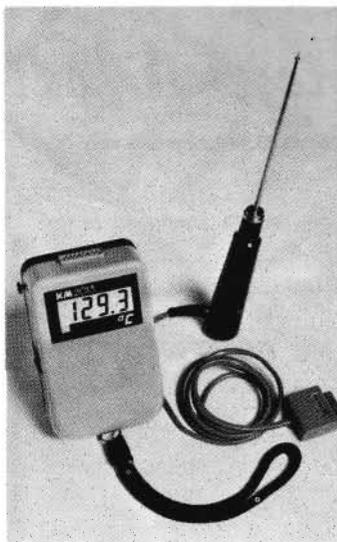
per 10 secondi dopo il rilascio del pulsante di azionamento; funzione valori di picco che permette di valutare i massimi valori raggiunti come di registrare i valori di picco in fenomeni transitori; uscita analogica linearizzata.
