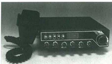
**Ricetrasmittitore Formac 700 Echo** ● Apparecchio per mezzi mobili con eco ● Il Formac 700 rappresenta l'alta tecnologia avanzata nel campo delle comunicazioni ● Un circuito PLL assicura la stabilità in frequenza ● Canali: 200 AM, 200 FM ● Frequenza: 25.165 ÷ 27.855 MHz ● Controllo in frequenza: PLL sintetizzata ● Alimentazione: 13,8 Vcc ● Potenza di uscita: Alta 10 Watt Media 5 Watt Bassa 1 Watt ● Modulazione: AM e FM
