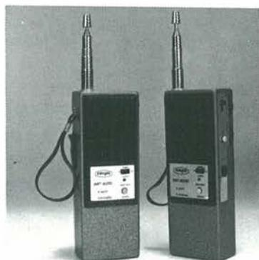
**Ricetrasmittitore Palmare a 3 canali 2 W** ● Canali: 3 di cui 1 quarzato ● Controllo Alta/Bassa potenza ● Tasto di chiamata e morse ● AGG: 55 dB AGC ● Sensibilità: 0,5  $\mu$ V a 10 dB ● Potenza d'uscita: 2 W ● Alimentazione: 12 V ● Presa per alimentazione esterna ● Sistema di ricezione supereterodina
