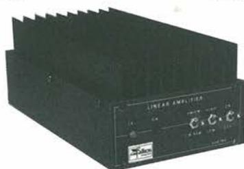
**Amplificatore lineare per auto Falkos 200 W** ● Gamma di funzionamento: 3 ÷ 30 MHz ● Pilotaggio: 1 ÷ 10 Watt AM 2 ÷ 20 W SSB ● Potenza in uscita: in AM 10 ÷ 200 Watt ● Potenza uscita: in SSB 20 ÷ 400 Watt ● Alimentazione: 12 ÷ 15 Volt cc. 25 A. max ● Sistemi d'emissione: AM, FM, SSB, CW ● Comando per uscita a metà potenza ● Dimensioni: 115 x 200 x 85
