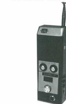
**EXCALIBUR 120** ● Ricetrasmittitore palmare ● Circuito: digitale con sintetizzatore PLL ● Canali: 40 da 26.965 a 27.405 MHz ● Modo di operazione: AM-FM ● Alimentazione: 12.6-15 VDC ● Semiconduttori: 19 transistor, 3 IC's, 14 diodi ● Peso: kg 1,3 ● Potenza RF input: 5 Watt ● Sensibilità: 1  $\mu$ V per 10 dB S + N/N ● AGC: 70 dB ● Uscita audio: 2 Watt
