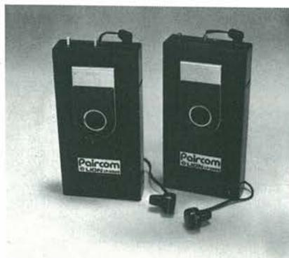
**Ricetrasmittitori Paircom** ● Nuovo sistema che permette l'utilizzo con la sola voce, senza l'impiego delle mani, da applicare al taschino, trasmette a mezzo di un microfono sensibilissimo alla voce e non ai rumori, ricezione in auricolare. ● 2 Canali ● Ricevitore: doppia supereterodina ● Sensibilità: 11 dB/ $\mu$ V ● Potenza trasmettitore: 75 mW ● Alimentazione: 3 V ● Frequenza: 172 ÷ 218 MHz
