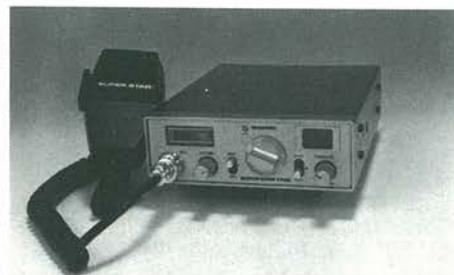
**Ricetrasmittitore Super Star 1700** ● Stazione mobile operante sulla banda CB costituito da un circuito "Phase Lock Cop" che assicura un preciso controllo della frequenza. ● Canali: 120 ● Frequenza: 27 MHz ● Controllo di frequenza: PLL sintetizzata ● Alimentazione: 13,8 Vcc ● Dimensioni: 180 x 198 x 60 mm. ● Peso: 2,3 kg ● Potenza uscita: 5 ÷ 10 Watt ● Sensibilità a 10 dB: 1,0  $\mu$ F
