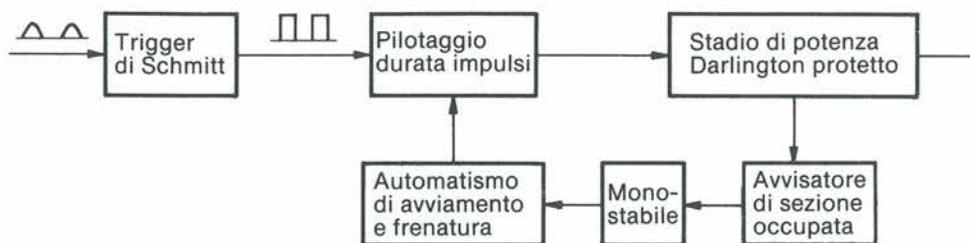
**Figura 1 - Stadi funzionali dello schema a blocchi. La parte superiore determina la velocità di marcia regolando la durata degli impulsi rettangolari, mentre la parte inferiore determina l'inizio, la durata ed il termine della sosta.**
