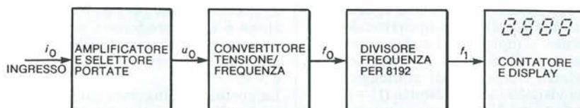
Figura 1. Schema a blocchi del Coulombmetro che illustra la teoria su cui si basa il funzionamento. Il convertitore tensione/frequenza fornisce una frequenza d'uscita di 81,92 kHz per una corrente d'ingresso di 1 A.
