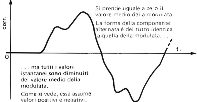
Si prende uguale a zero il valore medio della modulata. La forma della componente alternata è del tutto identica a quella della modulata. . .
