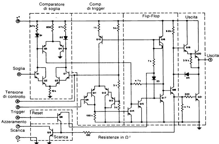
Figura 1-4. Circuito equivalente del timer 555 - RCS. (Per gentile concessione della RCA, Somerville, NJ)
