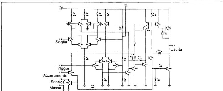
Figura 1-3. Circuito equivalente del timer 555 - Signetics - (Per gentile concessione della Signetics, Sunnyvale, CA)
