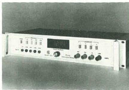
Il range della misura della fase o della generazione della fase è  $\pm 180^\circ$ . La fase viene indicata da un display a 3 1/2 digit con una risoluzione di  $0,1^\circ$ .
