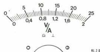
Figura 7. La nuova scala da applicare allo strumento a bobina mobile da 1 mA.
