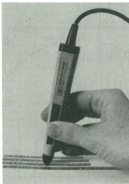
segnale ad onda quadra. Dato che della luce ambiente non ci si può molto fidare, potrebbe essere una buona idea quella di montare una lampada vicino al fototransistor, assicurandosi che la luce cada sulle barrette e non su di esso. Questo è possibile interponendo un pannello tra i due elementi. Si tratta dunque di una cosa semplice?
