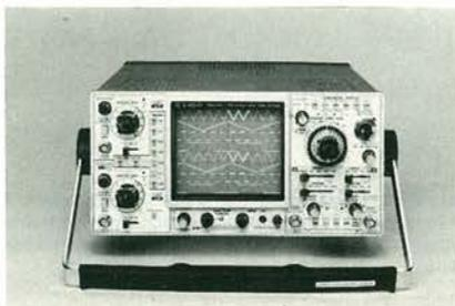
ce, sweep ritardato per consentire di osservare contemporaneamente lo sweep ritardato e quello principale, sweep A e B completamente indipendenti, impedenza di 50  $\Omega$  selezionabile per la visualizzazione dei segnali e degli impulsi veloci sulle linee a 50  $\Omega$ , intensità dello sweep principale e di quello ritardato regolabile in modo indipendente, potenziale di accelerazione di 16 KV e messa a fuoco automatica.
