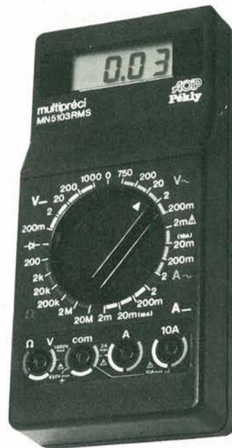
Dotato di 28 funzioni o calibrazioni, offre una autonomia maggiore di 1500 ore. La sua facilità di impiego è accompagnata da dispositivi di sicurezza e protezione totali. I campi di misura vanno da 200 mV a 1000 V in continua e da 200 mV a 750 Veff in alternata per le tensioni, da 2 mA a 10 A (vero valore efficace) per le correnti e da 200  $\Omega$  a 20 M $\Omega$  per le resistenze.
