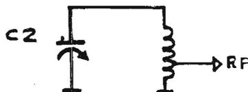
I 75  $\Omega$  che lei non trova assolutamente, esistono; ma non sono certamente 75  $\Omega$  resistivi che si possono misurare con un multimetro! Si tratta dell'impedenza che si trova tra l'uscita RF e la massa a frequenze di centinaia di Megahertz!
