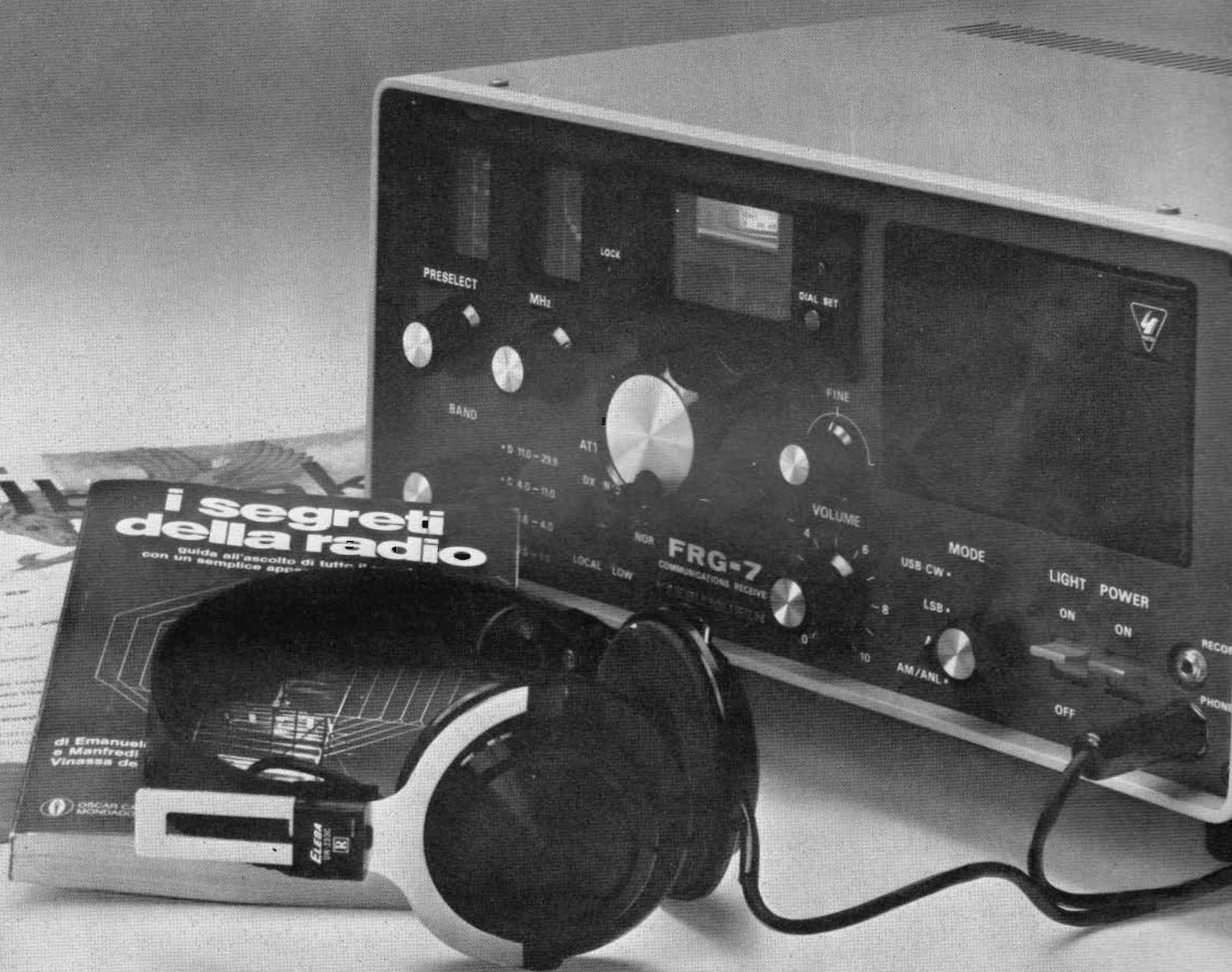
Il modello FRG-7 è un ricevitore sintetizzato, a stato solido in grado di coprire l'intera gamma delle alte frequenze, da 500 KHz a 29,9 MHz.
