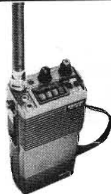
IC 2 E: ricetrasmittitore portatile per i 2 m FM - 800 canali - 1,5 w. da 144 a 147,995 Mhz.
