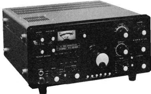
FT 101 ZD: ricetrasmittitore per bande radioamatoriali e CB - WWW/JJY-SSB-CW-AM 180 W. - VOX - AGC.
