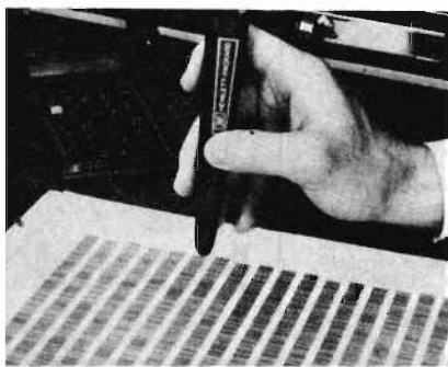
Figura 1 - La «bacchetta» luminosa della HP per la lettura di codici a barre, che può essere collegata ad un calcolatore del tipo HP-41C.
