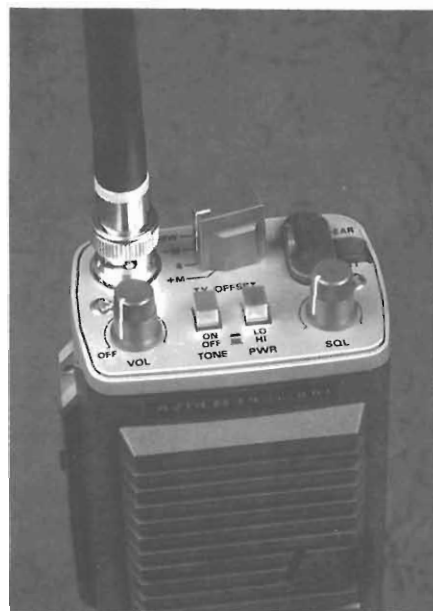
Nella foto vi presentiamo la parte superiore del ricetrasmittitore Azden pcs-300 descritto in questo articolo per mostrarvi i principali comandi dell'apparato.
